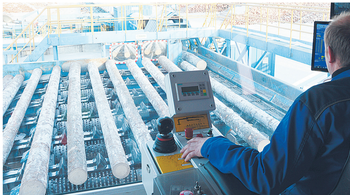
Находясь за пультом управления, оператор на каждом этапе сортировки отслеживает качество бревен
